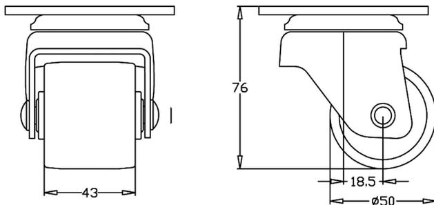
**Рисунок 5. Внешний вид ролика REC-СВ-L**
