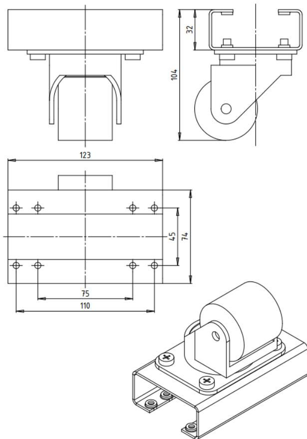
**Рисунок 3. Внешний вид ролика REC-СВ-М**
